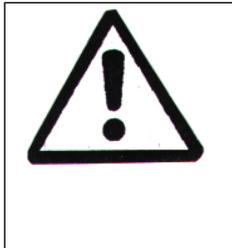
**Vor Wartungs- und Reinigungsarbeiten an der Messerschleifmaschine den Netzstecker ziehen. Niemals Sicherheitseinrichtungen entfernen oder durch Veränderungen an der Maschine außer Betrieb setzen! Änderungen und Reparaturen an der Elektrik dürfen nur durch eine Elektrofachkraft ausgeführt werden! Nur Original Ersatzteile der Fa. GS-Schleiftechnik verwenden!**
